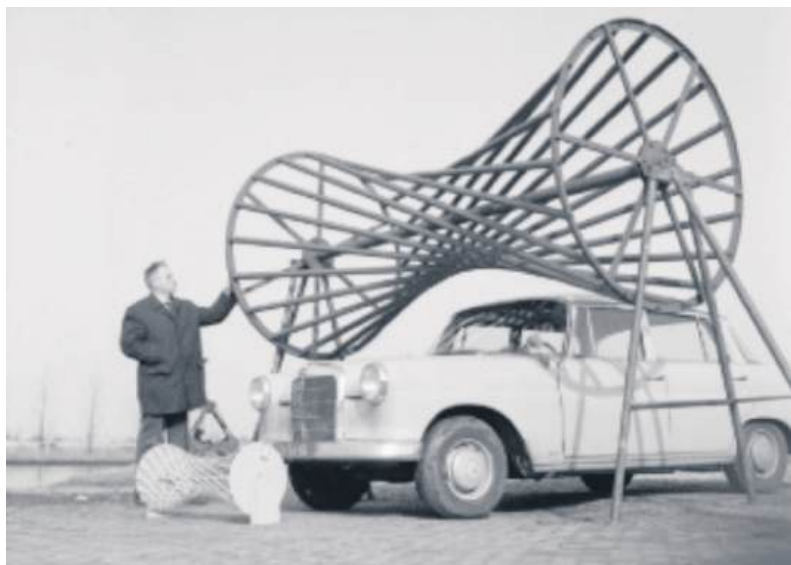
■ Diabolorollen voor bandtransporteurs, een vinding uit 1964.
